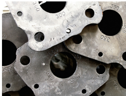
Длина стойки – четка заштампована в концевые плиты стоек PEP Ergo.
