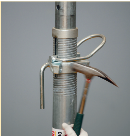
Регулирующая гайка оснащена характерными ударными выступами, которые определяют направление ударов молотком при опускании.
