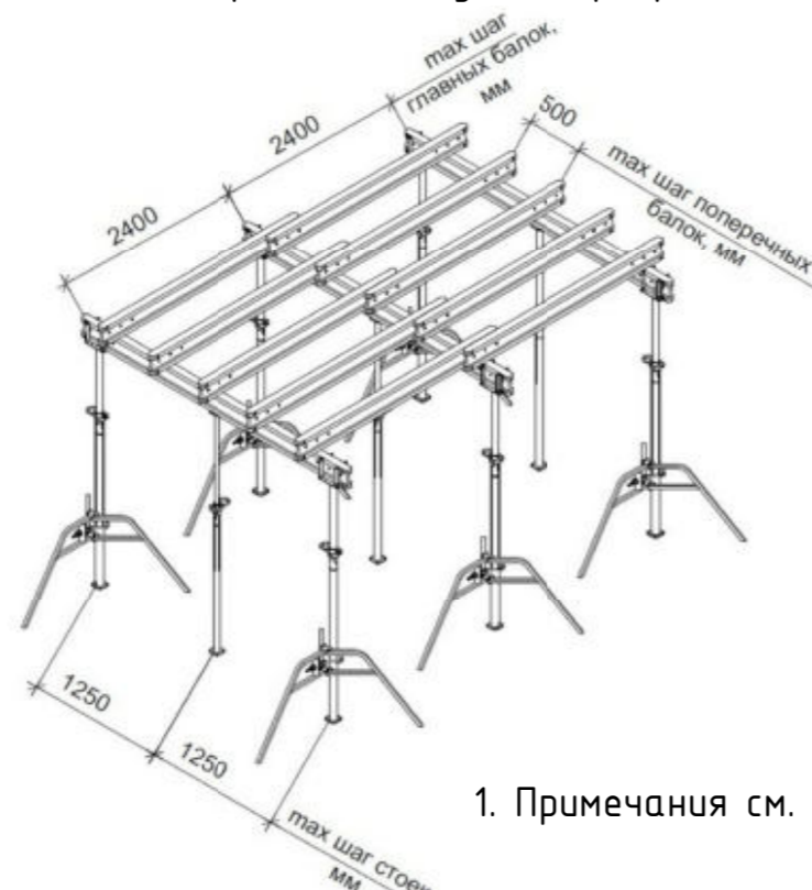
3D схема с максимальными значениями (шаг/пролет) опалубки перекрытия
